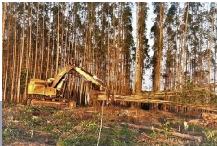
Taladora/apiladora en la cosecha mecanizada de una plantación clonal de eucalipto ( Eucalyptus urophylla ) de 5 años. Agua dulce, Veracruz (2020).
